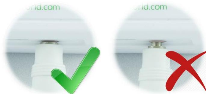
**NOTA!** Verificate che il sensore sia inserito nella presa jack rossa da 3.5mm fino alla fine. La connessione viene segnata e dovete assicurarvi che non vi sia spazio tra il connettore del sensore ed il jack!
